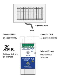
IMPORTANTE: no conectar el ZBUS en los conectores reservados para la conexión de la rejilla ya que pueden dañar el equipo.
