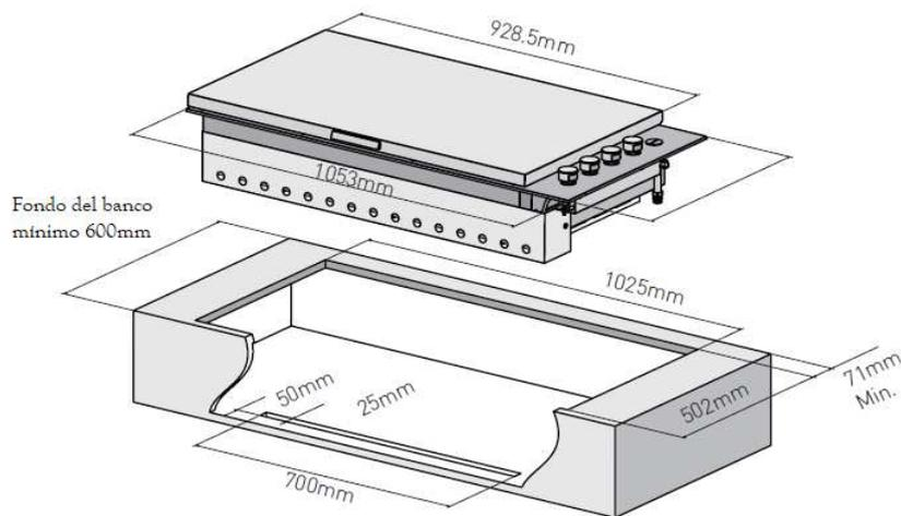
Ventilación alternativa en la base de la construcción (frontal cortado en la imagen para mejor explicación).
