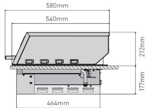
**ADVERTENCIA:** Este aparato requiere ventilación. Se aconseja un espacio abierto. Se puede poner una rejilla si se desea. Esta zona de ventilación permitirá que entre aire en la construcción para asegurar la correcta combustión de los gases y la correcta extracción de productos inflamables. El espacio de ventilación no debe medir menos de 700mmx25mm
