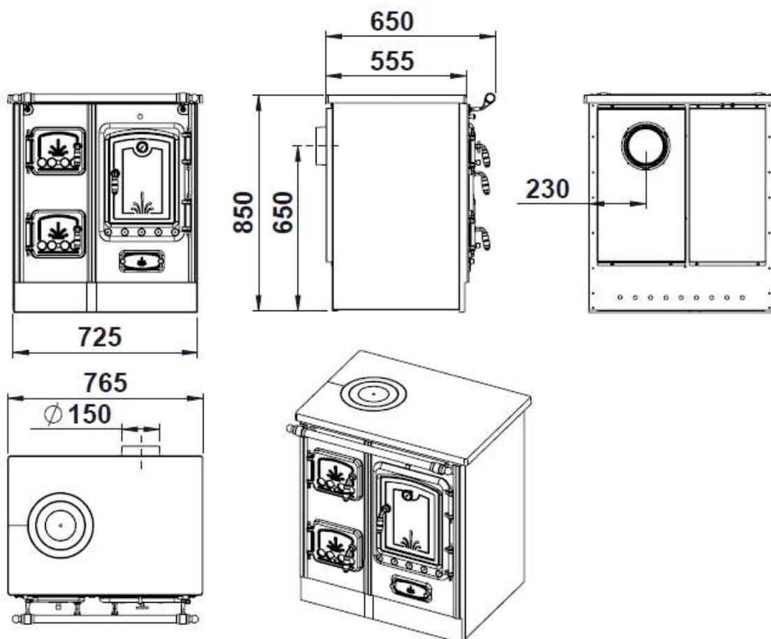
Figura n<sup>o</sup>1 - Dimensiones en mm del aparato Lis 5T
